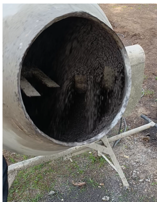
Stabilizer a kamenivo zmiešané v miešačkách na betón rôznych typov a veľkosti
